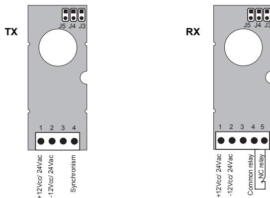
**SISTEMA DI SINCRONISMO - SYNCHRONISM SYSTEM - GLEICHLAUFSYSTEM - SYSTÈME DE SYNCHRONISME - SISTEMA DE SINCRONÍA****IT**
